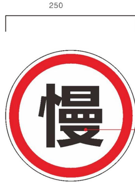
铝板底+PVC胶粘，Ⅱ类反光膜，含安装抱箍与滑槽。
