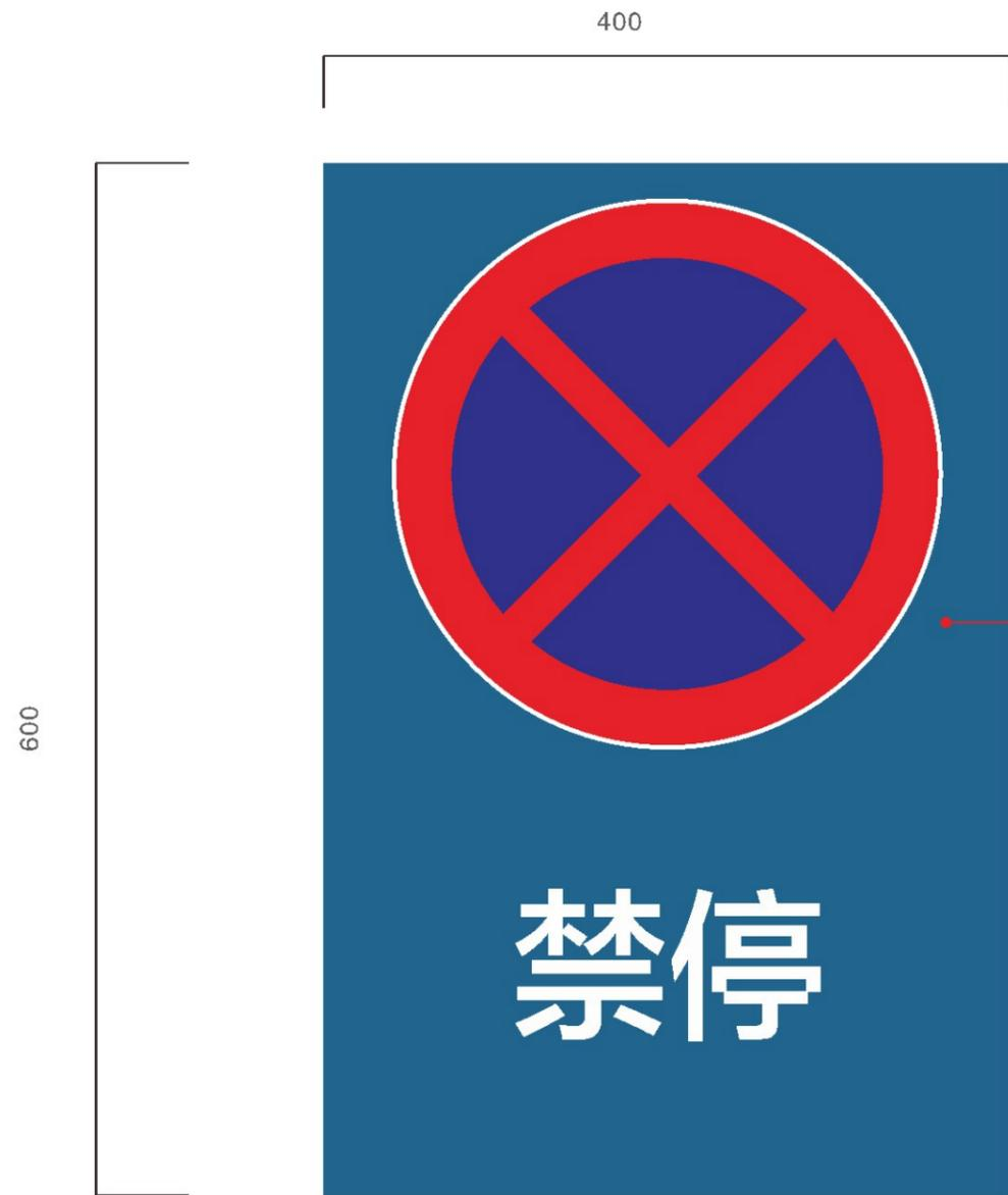
铝板底+PVC胶粘，II类反光膜，含安装抱箍与滑槽。
