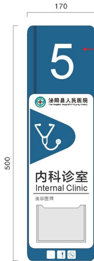
采用 $\geq 1.2\text{mm}$ 的201#不锈钢折弯切割焊接造型，表面汽车烤漆内容丝印。
