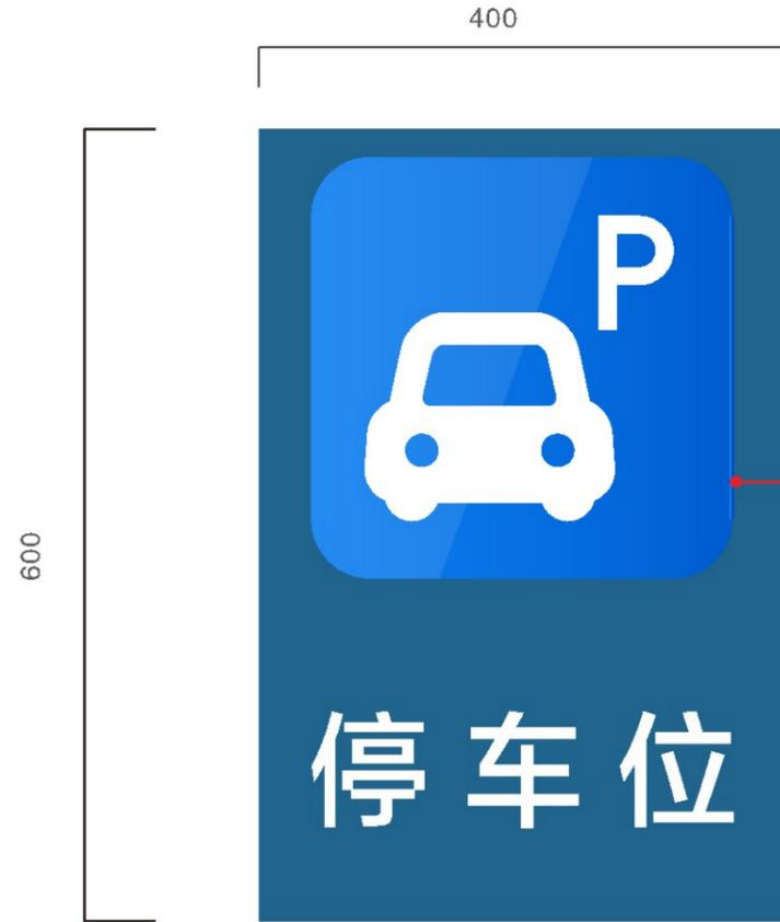
铝板底+PVC胶粘，Ⅱ类反光膜，含安装抱箍与滑槽。
