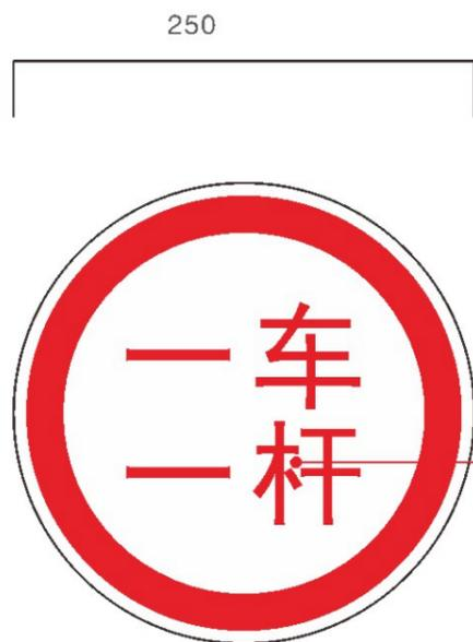
铝板底+PVC胶粘，II类反光膜，含安装抱箍与滑槽。
