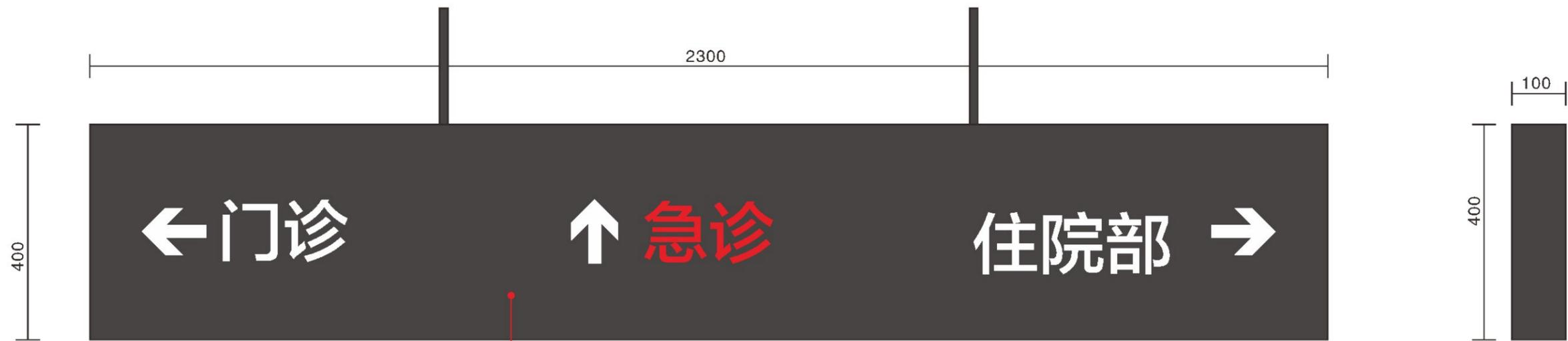
采用 $\geq 1.2\text{mm}$ 的201#不锈钢折弯切割焊接造型，表面汽车烤漆
