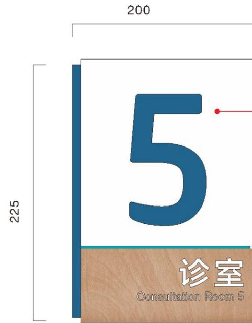
采用不小于5mm厚的亚克力亚克力切割，打磨，图文UV（亚克力板：拉伸强度 $\geq 70\text{MPa}$ ，透光率 $\geq 91\%$ ）。
