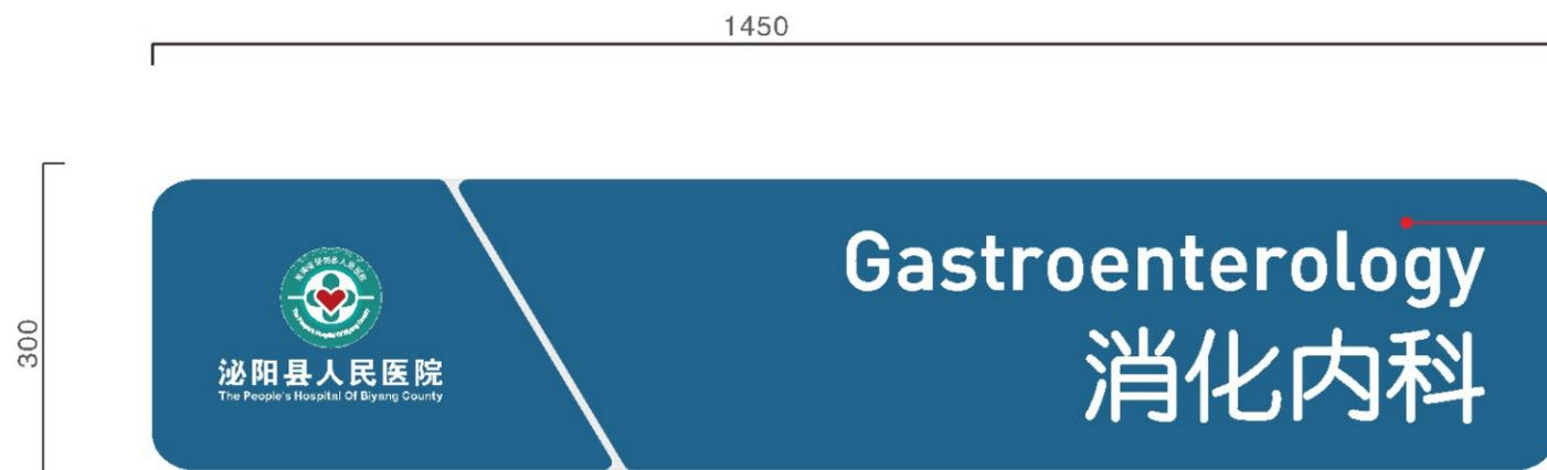
采用 $\geq 1.2\text{mm}$ 的201#不锈钢折弯切割焊接造型，表面汽车烤漆。
