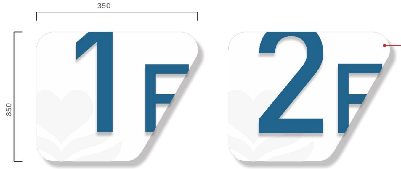
采用 $\geq 1.2\text{mm}$ 的201#不锈钢折弯切割焊接造型，表面汽车烤漆内容丝印。
