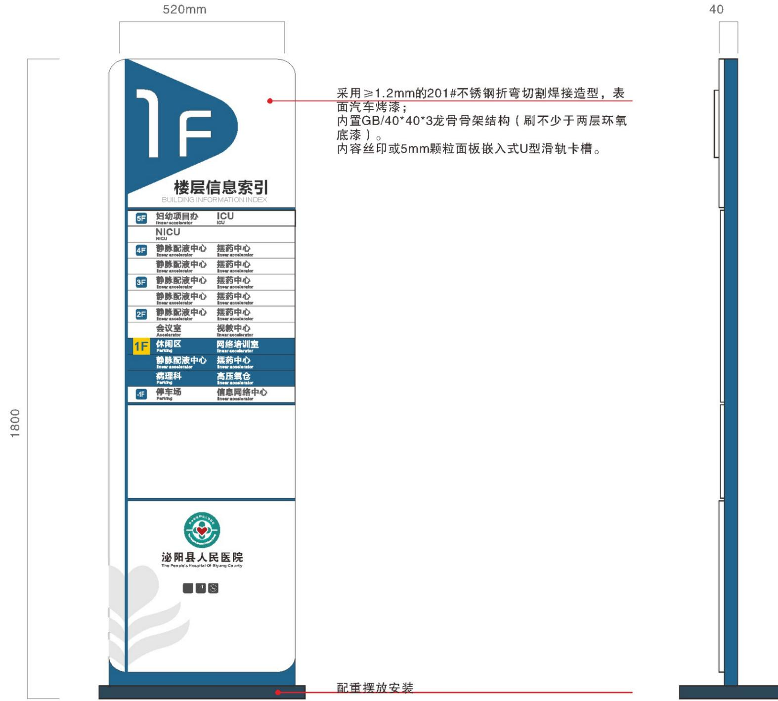
采用不小于8mm厚的亚克力激光切割面板，背面分色烤漆，图文丝印。
