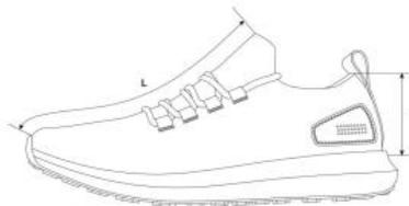
图3 成品尺寸测量部位示意图
