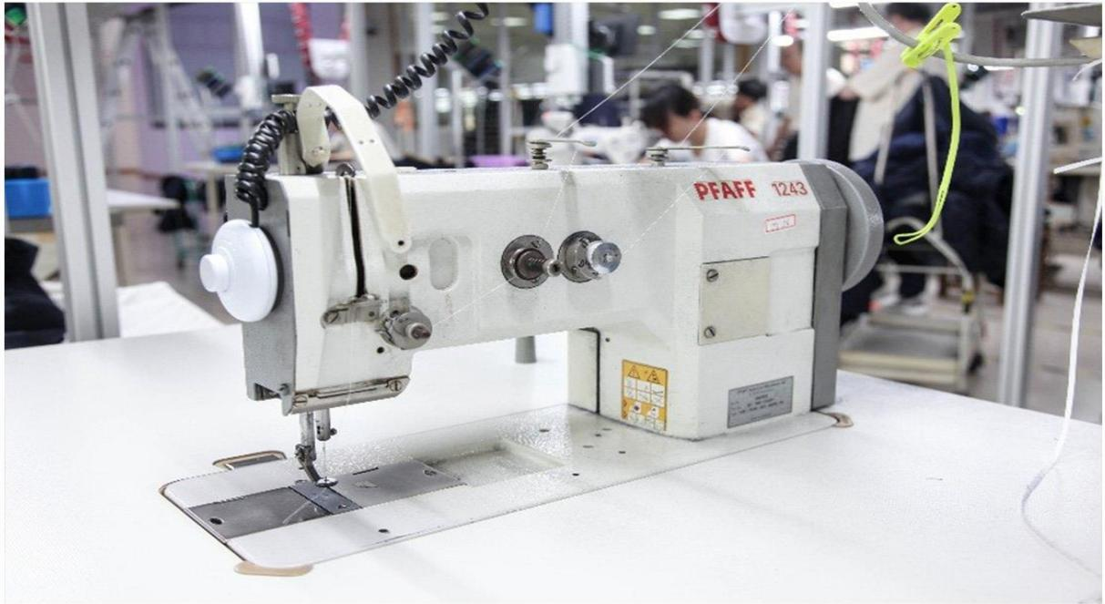
▲百福1243型，带自动剪线，对胸衬进行准确、快速定位。
