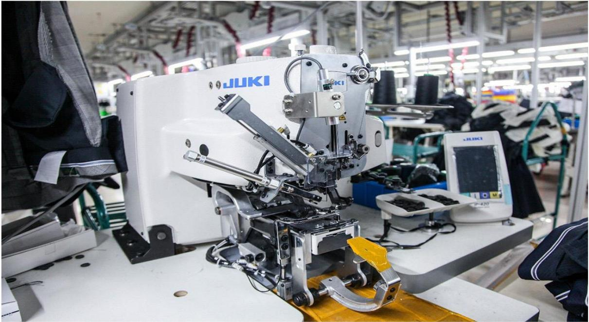
▲日本重机自动绕脚钉扣机，钉扣成型的钮扣能自然站力，绕脚牢固。
