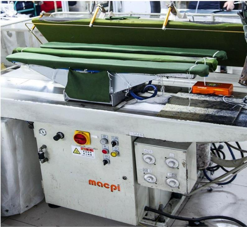
▲压烫省缝三条缝机
