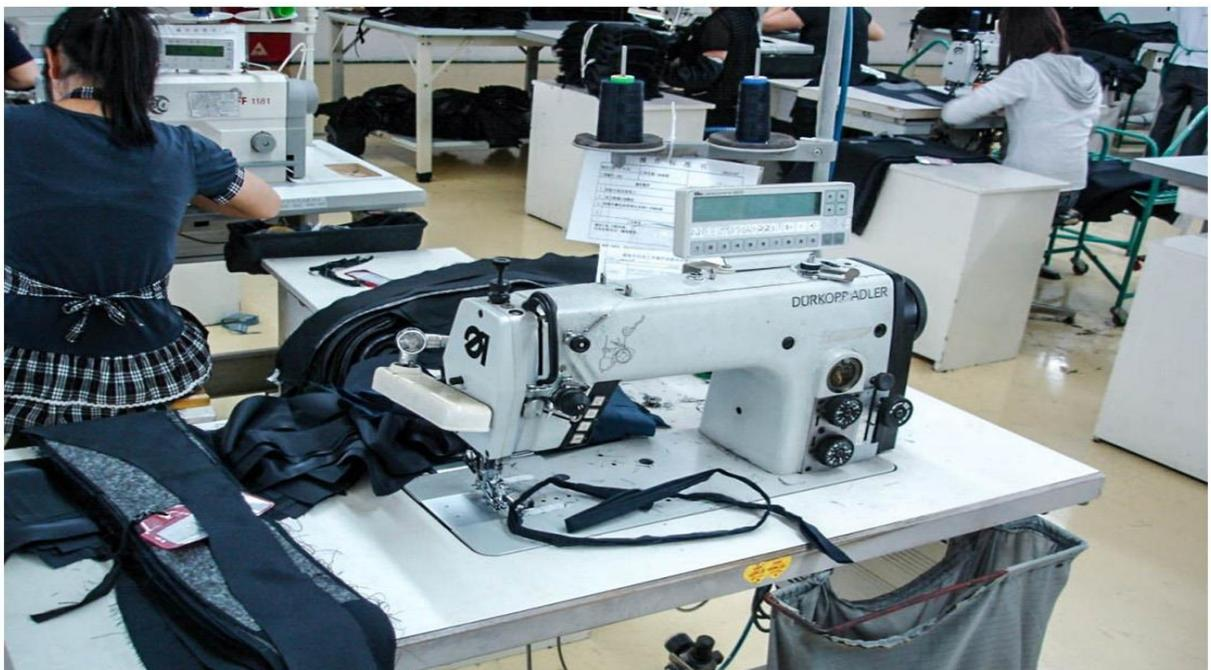
▲裤子门襟拉链缝制上下门襟平整、不起皱、拉链顺直。
