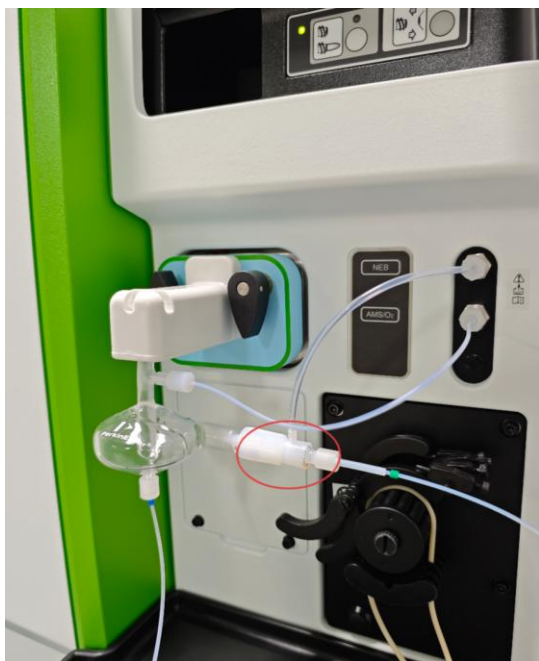
*2.1.2 雾化室：带气体稀释接口的超净旋流型雾化室。 通过 不通过
