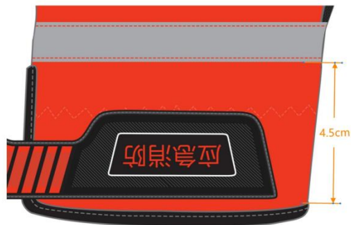
手背反光条与包边 条的距离 尺寸：4.5cm
